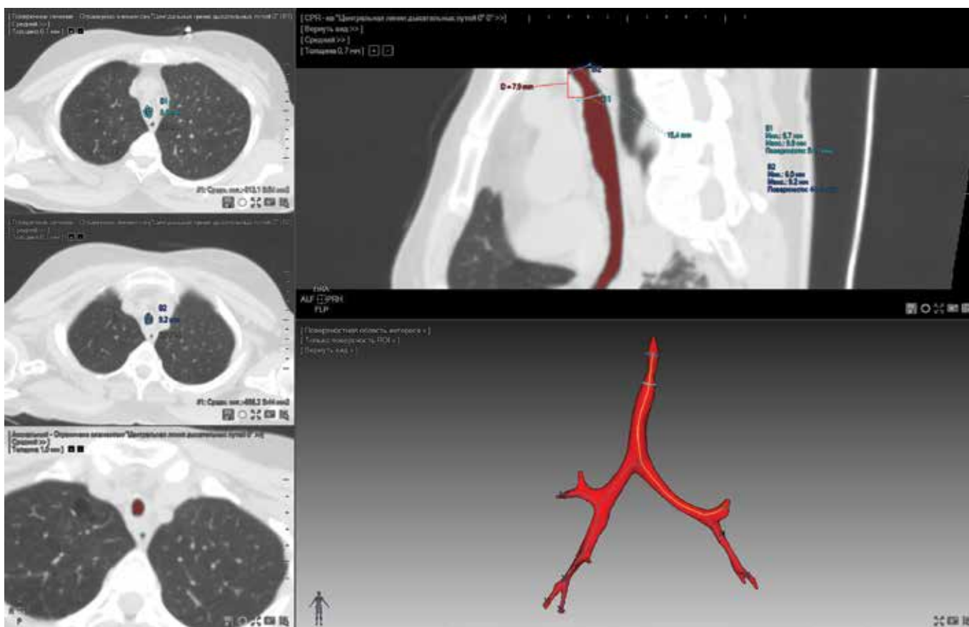
Рис. 10. Программный пакет «Планирование стента». На сагиттальной проекции выставлены метки на интересующих уровнях. Выделенные уровни проецируются на 3D-изображение трахеи и бронхов. На выделенных уровнях происходит автоматическое выделение контуров трахеи (отображается на аксиальных срезах), обозначение максимального и минимального диаметров на каждом интересующем уровне.
